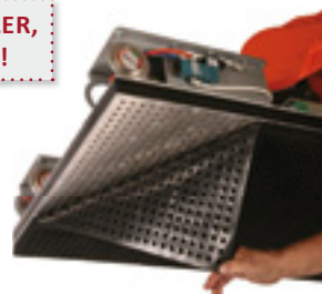
Austausch der Saugmatte ohne Werkzeug
